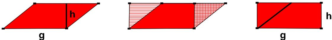
Diese Zerlegung zeigt: Der Flächeninhalt des Parallelogramms ist das Produkt aus der Grundseite  $g$  und der Höhe  $h$ :  $A = g \cdot h$ .
